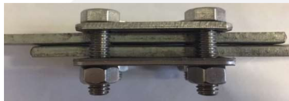
[Fot.4] Zdjęcie złącza 4-śrubowe typu bednarka-bednarka – brak dokładnego przylegania
